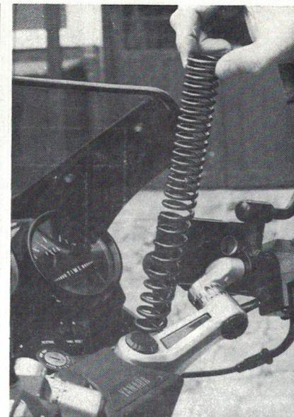
PHOTO 24 : Extrémité supérieure des ressorts de fourche (Photo RMT)
