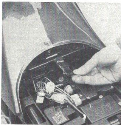
PHOTO 5 : Patte-agrafe du réservoir (Photo RMT)
